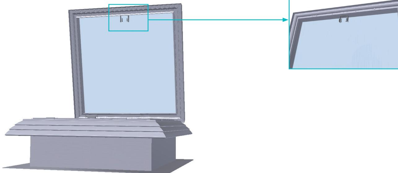
**9** Retirer la goupille et l'axe du vérin. Fermer l'ouvrant et introduire l'axe. Verrouiller avec la goupille
