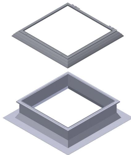
**3** Utiliser les vis 4,5 X 45 mm fournies pour fixer le dormant sur l'embase (utilisez les trous pré-perçés)
