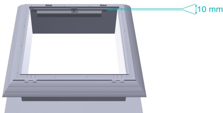
**5** Positionner les 1/2 charnières du cadre ouvrant dans les 1/2 charnières du cadre dormant (manipulez avec prudence car le remplissage est en verre)
