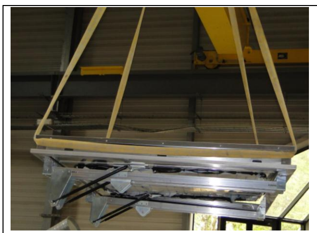
Vue de dessous (vérins électriques)
