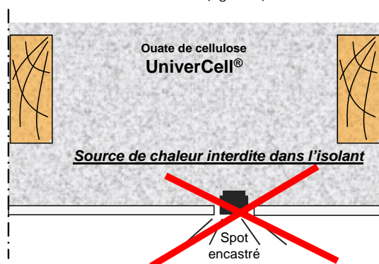
Figure 2 : Spot encastré non protégé interdit dans l'isolation
