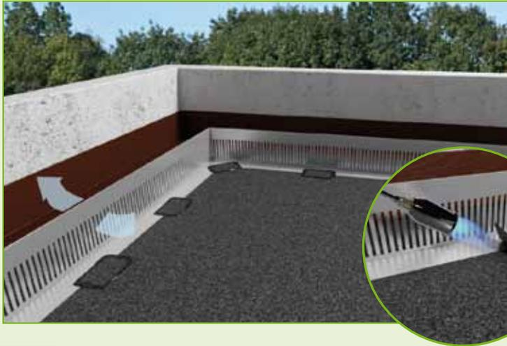
Les bandes pare-gravier (équerres métalliques ajourées) délimitent les zones stériles. Une zone stérile de 40 cm est recommandée en périphérie de la toiture et autour des émergences.
