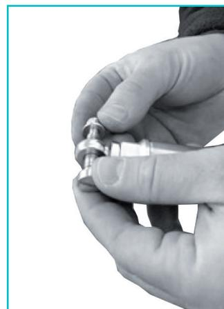
**7** Introduisez le vérin entre le système de verrouillage et le crochet de verrouillage
