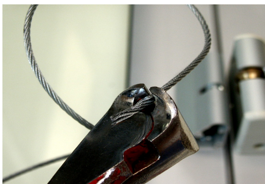
1) Couper proprement le bout du câble.
