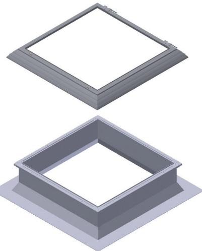
**3** Utiliser les vis 4,5 X 45 mm fournies pour fixer le dormant sur l'embase (utilisez les trous pré-percés)
