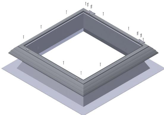
**4** Utiliser les vis 4,8 X 45 mm fournies pour positionner le vérin à l'intérieur de l'embase (à 10 mm du relevé d'eau), chaîne du vérin centrée sur l'embase
