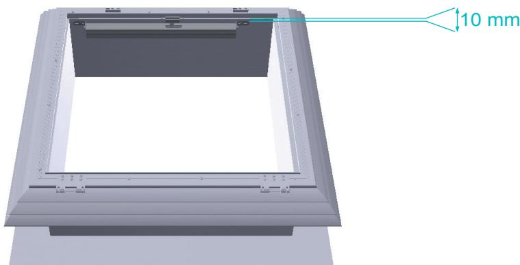
**5** Positionner les 1/2 charnières du cadre ouvrant dans les 1/2 charnières du cadre dormant (manipulez avec prudence car le remplissage est en verre)
