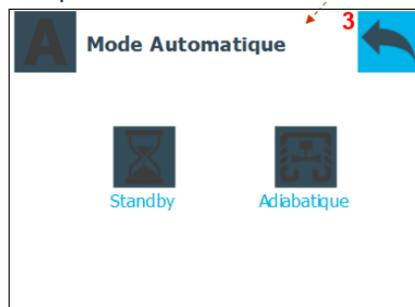
Cliquez sur l'icône d'un mode pour imposer ce mode de fonctionnement à l'installation. Une main apparaît alors en haut à gauche.
