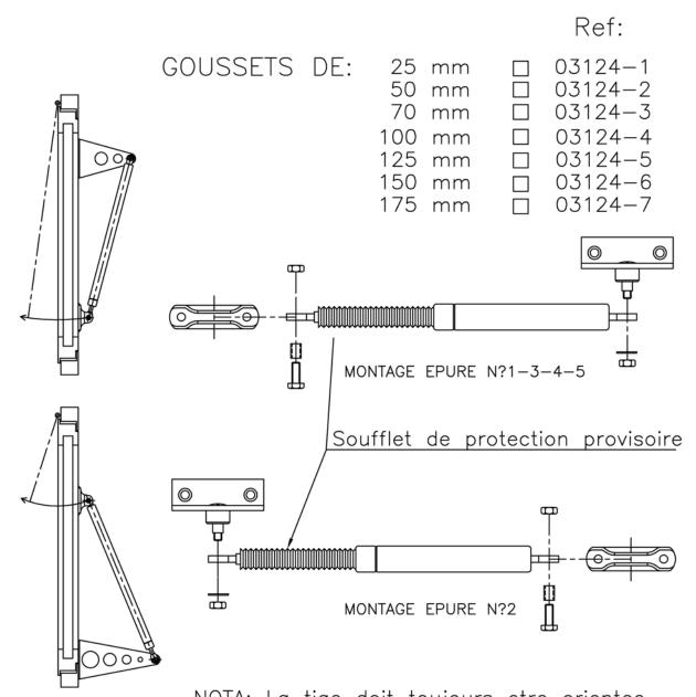
NOTA: La tige doit toujours etre orientee vers le bas Laisser la protection de tige durant toute la duree des travaux ,la retirer lors de la mise en service
