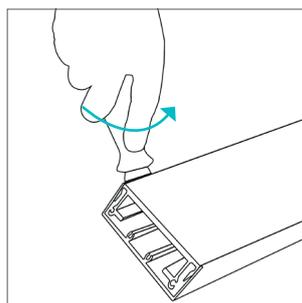
Etape 1 : Déclipser les deux profils à l'aide d'un outil assez large, type spatule (*ne pas utiliser de tournevis pour éviter toute déformation du profil*).
