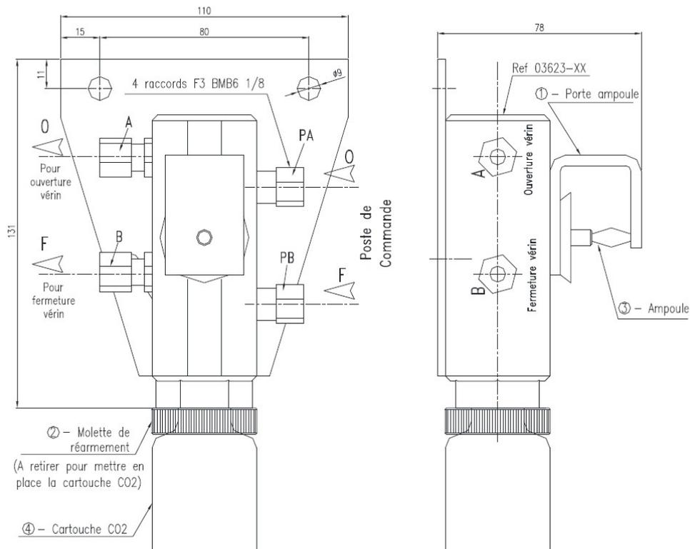
Différentes variantes suivant l'ampoule thermique équipant le déclencheur
