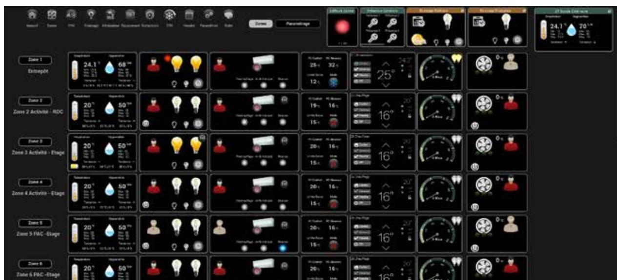
Ce superviseur compatible avec une GTB de **CLASSE A**, selon le décret BACS, permet de faire une **optimisation énergétique** d'un bâtiment pouvant prendre en fonction des configurations client jusqu'à :
