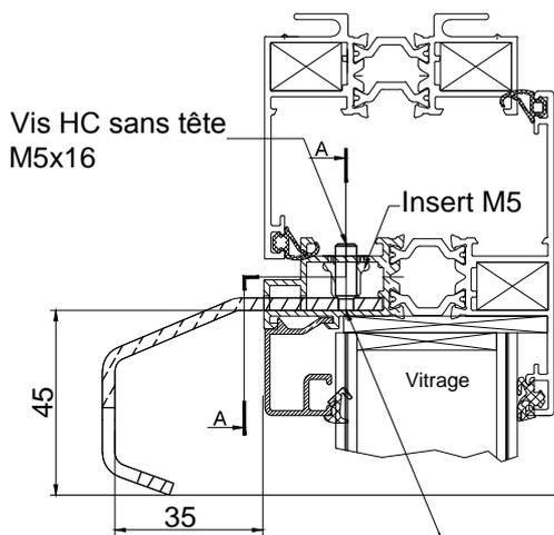
Blocage de la poignée par l'extrémité de la vis dans l'oblong de la poignée.
