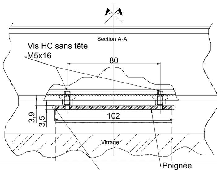
Usinage d'une rainure de 3.5 x 102mm pour le passage de la poignée ci-contre.
