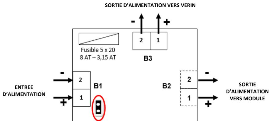
**Note : un module de ligne utilisé avec des appareils de toiture doit être prévu pour une intensité nominale maximum de 5,2 A**
