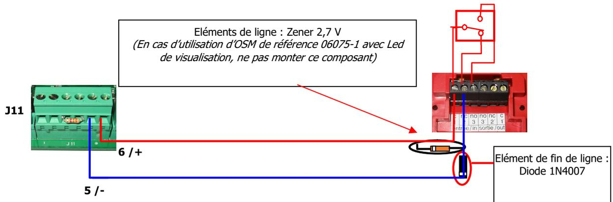
Il est impératif de placer la ferrite fournie sur cette ligne de commande, en prenant soin de la placer au plus près du bornier et en s'assurant que le câble fait deux tours dans cette dernière :
