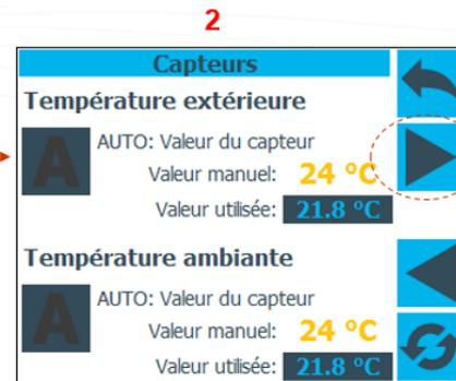
Afin d'effectuer des essais ou pour un mode de fonctionnement particulier, les valeurs des températures extérieures et ambiantes peuvent être forcées manuellement.
