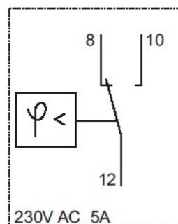
Si l'humidité relative mesurée tombe en dessous du point de consigne, le contact 12/8 s'ouvre et le contact 12/10 se ferme.
