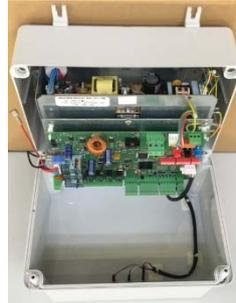
B. Débrancher secteur J2 et les cosses batteries J5A et J5B
