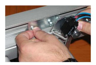
3- Placer les inserts dans la rainure du profil puis serrer les vis à l'aide d'une clé allen.
