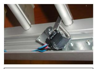
4- Une fois l'ensemble monté sur l'AIRLAM V2 et raccordé électriquement, procéder au réglage des contacteurs de position suivant les instructions de la page suivante.
