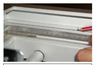
2- Effectuer le traçage pour positionner le dispositif à 135 mm de la traverse haute du cadre suivant la photo ci-dessus.
