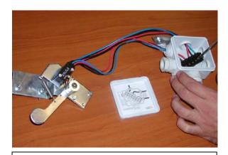
1- Le kit est constitué de l'ensemble contacteur, de la boite de raccordement montée sur sa platine, de la notice de montage. Enlever le couvercle de la boîte de raccordement puis procéder au branchement des contacteurs conformément à la notice collée sur le couvercle.
