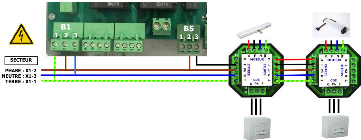
**Nota :** la sortie auxiliaire S3 (disponible sur le bornier B5) est en sécurité positive : en cas défaut d'alimentation de la centrale, le signal délivré correspond à un défaut pluie et vent.
