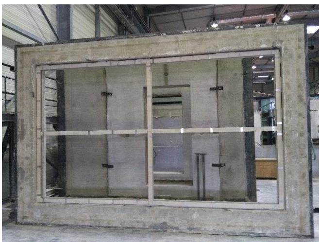
Mise en place de l'ossature dans le cadre support
