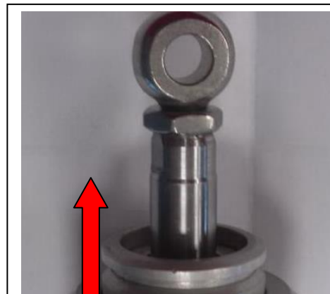
Déverrouillage manuel d'un vérin tige sortie : tirer la bague
