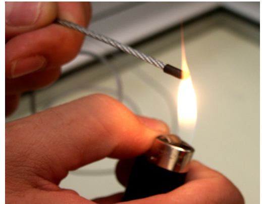
2) Placer la gaine thermo-rétractable et chauffer le bout du câble.
