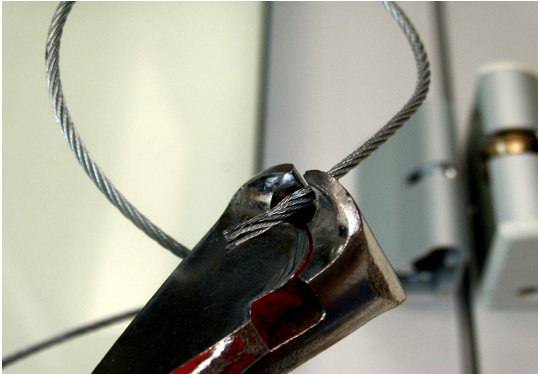
1) Couper proprement le bout du câble.
