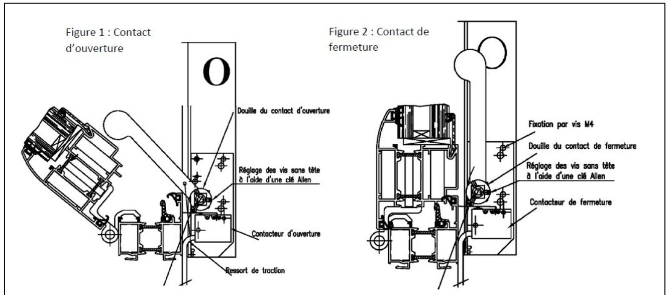
La tête de vis doit actionner le contact d'ouverture par l'intermédiaire de la languette.
