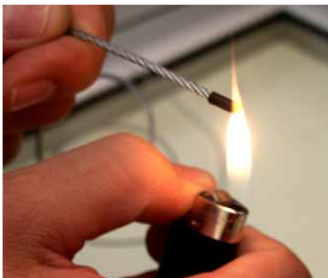
8- Chauffer le bout du câble.
