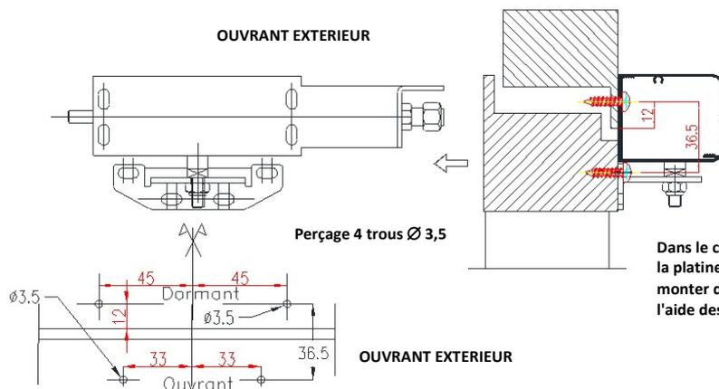
Dans le cas du verrou extérieur fixé, la platine en "U" sur le dormant, puis monter de verrou sur la platine à l'aide des vis fournies.
