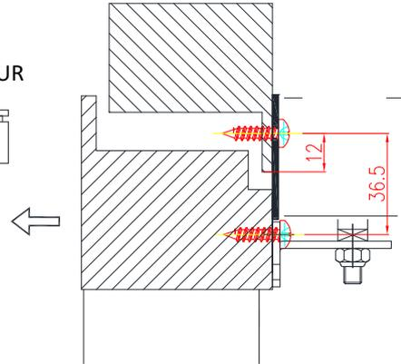
Dans le cas du verrou extérieur fixer, la platine en « U » sur le dormant, puis monter le verrou sur la platine à l'aide des vis fournies.
