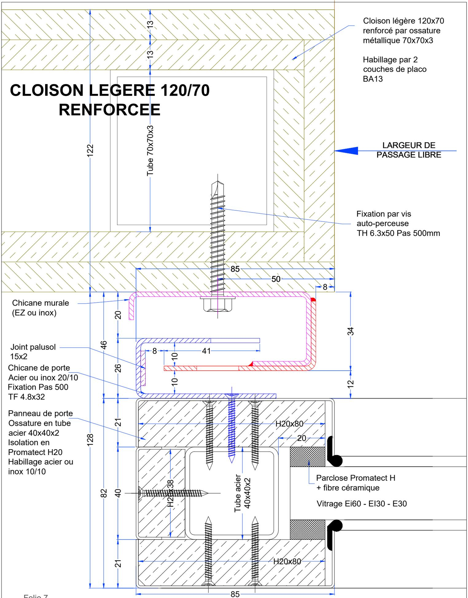
Cloison légère 120x70 renforcée par ossature métallique 70x70x3
