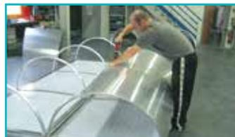
**9** Visser les protections solaires sur le deuxième vantail (commencer par les deux premières vis de chaque voile pour éviter que les voiles ne se plient à l'ouverture de l'appareil).
