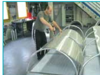
**10** Déverrouiller l'appareil en insufflant de l'air à l'aide de la pompe dans le tuyau d'ouverture (bleu), puis aider manuellement à l'ouverture.
