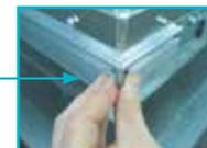
**2** Déverrouiller l'appareil en insufflant de l'air dans le tuyau d'ouverture (bleu), puis aider manuellement à l'ouverture.
