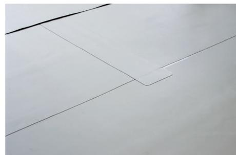
**FLAGON Eco F** eignet sich zum Einflämmen auf folierten bituminösen Zwischenlagsbahnen. Für eine fachgerechte Lagesicherung muss hierbei der gesamte Dachschichtenaufbau bis zur Tragschale untereinander verklebt werden. Hierzu wird auf die verlegte Dämmstoffschicht die entsprechend geeignete und geprüfte bituminöse Zwischenlagsbahn entsprechend der Vorgabe verlegt, und die FLAGON Eco F eingeflämmt. Auf der bereits verlegten Bitumenbahn wird die FLAGON Eco F lose und faltenfrei mit 8 cm
