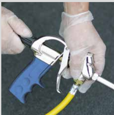
1- Dévissez la vis de réglage de débit.
