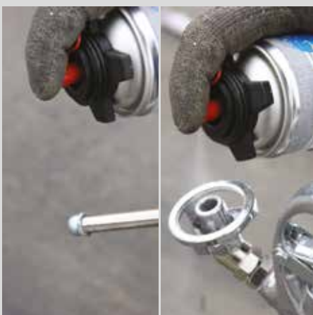
7- Fermer la valve du canister et nettoyer les résidus de colle présents sur le pistolet. La colle séchée ne peut être enlevée que mécaniquement.
