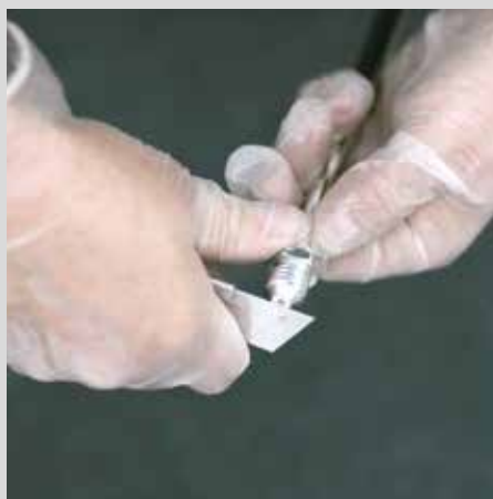
2- Éliminer les résidus de colle sur le gicleur du pistolet.
