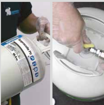
4- Agiter vigoureusement le canister et ouvrir la valve.
