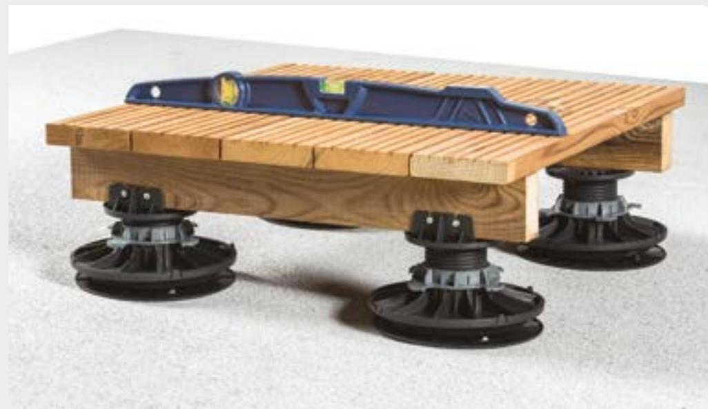
Les dalles bois n'ayant pas un poids suffisamment important pour stabiliser correctement les embases, nous préconisons de les utiliser uniquement avec des plots de 25 à 40 mm, de 40 à 60 mm et de 60 à 90 mm.
