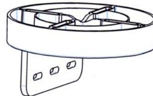
Face inférieure de la tête de plot pour lambourdes s'emboîtant dans les 4 ailettes en partie supérieure des plots SOPREMA
