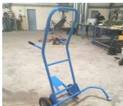
Diable de déplacement et de chargement des rouleaux.
