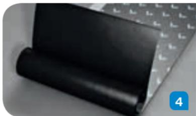
Trennfolie mit beiden Händen halten. Langsames Abziehen. Eingerollte Bahn auf den Untergrund abrollen und verkleben.
