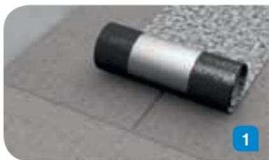
Das Fugenband SOPRAJOINT WF auf die gewünschte Länge zuschneiden. Die Überlappung zurücklegen; sie beträgt bei jedem Stoss **12 cm**. Die Alufolie sorgfältig auf **10 cm** retourschneiden. Achtung Fugenband nicht verletzen.
