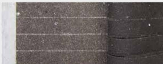
Il lato dei prodotti **Colphene BSW** rivolto verso il calcestruzzo è rivestito con speciali cristalli in biossido di silicio su un apposito bitume modificato con SBS. Appena inizia l'indurimento del calcestruzzo, questa superficie dalla speciale formulazione si ammorbidisce e vi aderisce in modo permanente. In questo modo si crea un collegamento continuo con il calcestruzzo, che impedisce la migrazione dell'acqua tra l'impermeabilizzazione e il calcestruzzo (a prova di infiltrazione).
