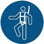
È richiesto l'uso dei dispositivi di protezione individuale anticaduta (secondo PSAgA EN 361 e EN 363), osservando rigorosamente le istruzioni del produttore.
