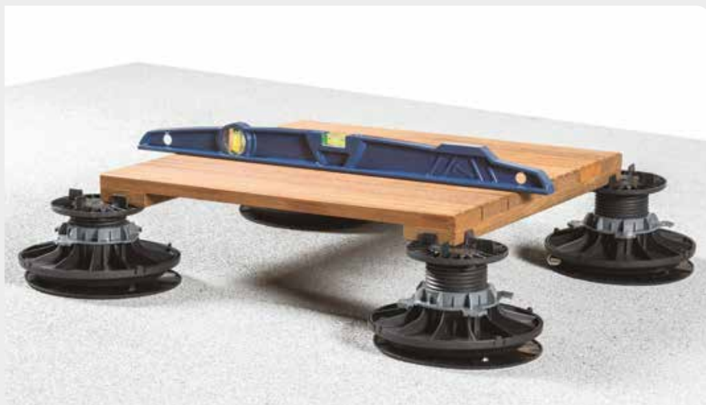
Holzplatten sind nicht schwer genug, um die Grundplatten richtig zu stabilisieren. Wir empfehlen, sie ausschliesslich mit Stelzträgern mit einer Höhe von 25 bis 40 mm, 40 bis 60 mm und 60 bis 90 mm zu benutzen.
