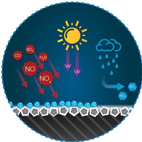
Los gránulos blancos protegen mejor las membranas gracias a un recubrimiento **D-TOX** basado en dióxido de titanio (TiO<sub>2</sub>).
