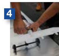
Draai de kop terug op de koker en bevestig dan de lijmgeleider aan de kop door middel van de draaimoer.
