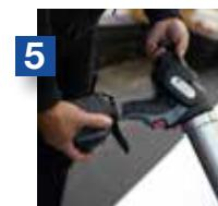
Zorg dat de batterij opgeladen is en steek deze dan in het apparaat.
